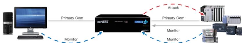
Fig. 3. : Plateforme de test ATP (Achilles Test Platform) [source Achilles]
